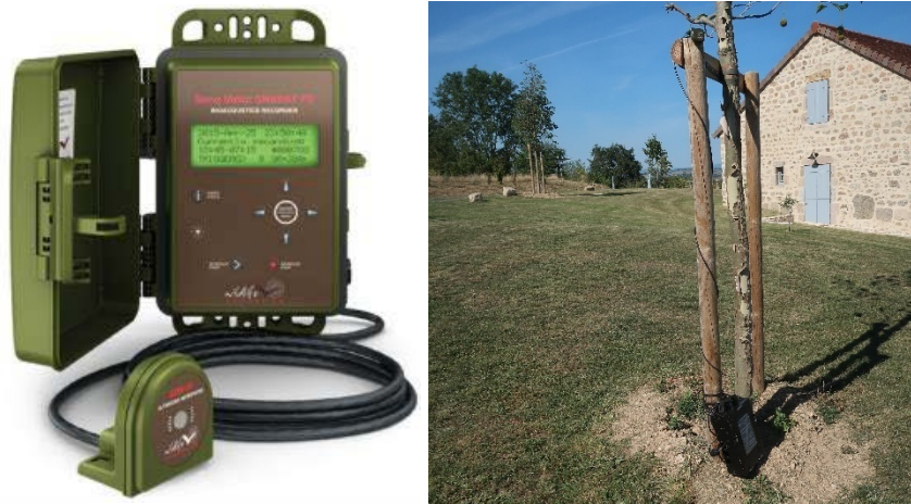
Photo 2. Enregistreur automatique SM4Bat et micro mis en place © P. Brunod.
