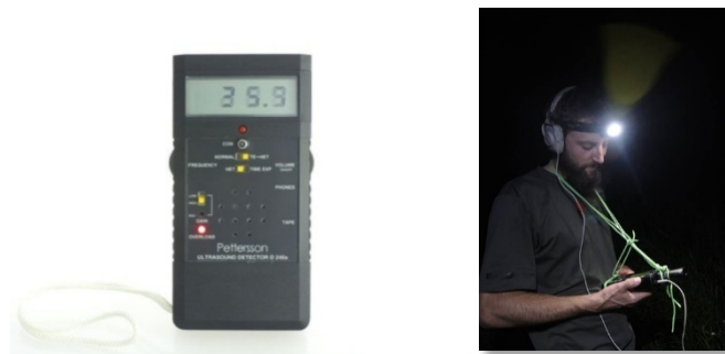
Figure 2. Détecteur d'ultrasons D240X Petterson et chiroptérologue sur le terrain.
